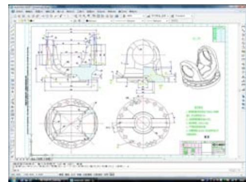
图七、生成后的法兰叉头工程图
