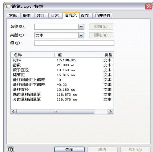
图22 添加到自定义特性中的相关设计参数
