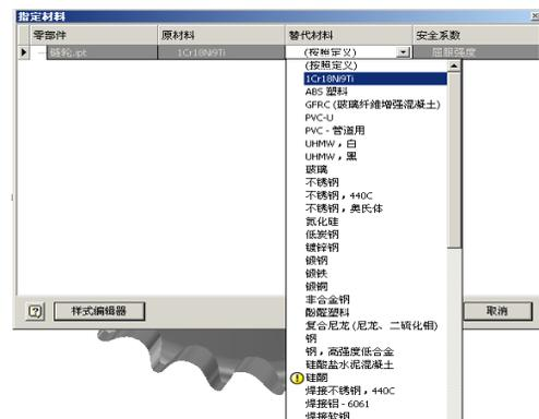
图12 链轮有限元分析指定材料
